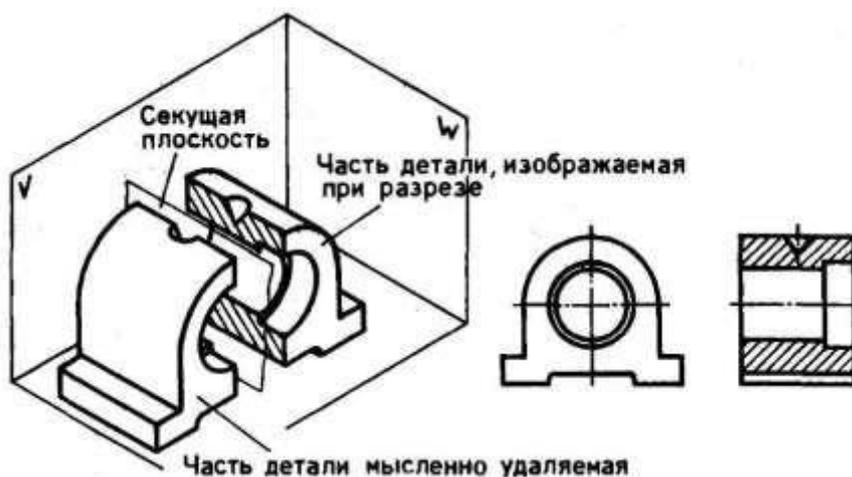
Рис.7. Профильный разрез.
