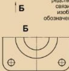
Дополнительный вид может быть ограничен линией обрыва (вид А) или не ограничен (вид Б).
