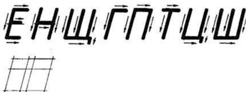
Рис. 2. Начертание прописных букв, состоящих из горизонтальных и вертикальных элементов, и построение вспомогательной сетки
