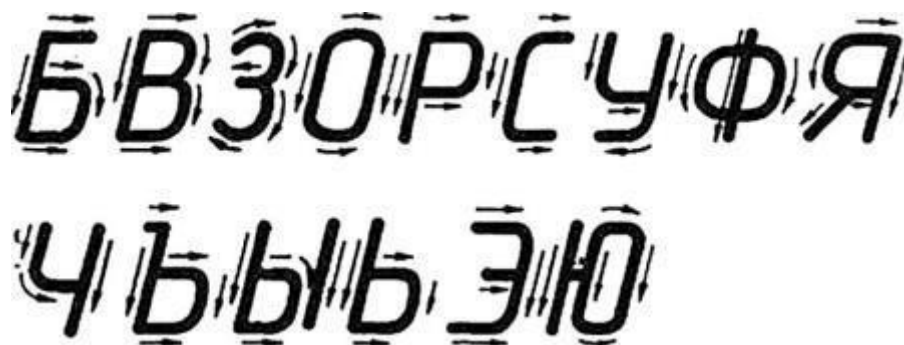
Рис. 4. Начертание прописных букв, состоящих из прямолинейных и криволинейных элементов
