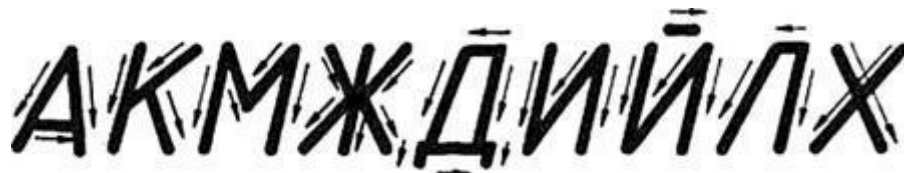
Рис. 3. Начертание прописных букв, состоящих из горизонтальных, вертикальных и наклонных элементов
