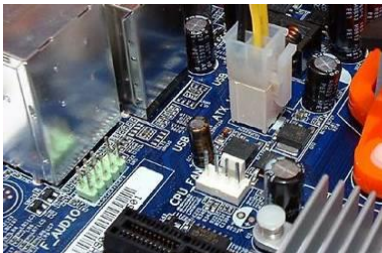
Рисунок – Подключение 4-контактной вилки ATX 12V
