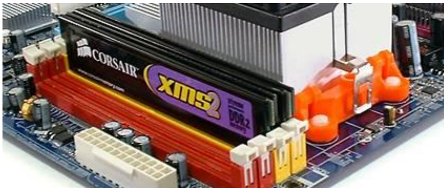
Рисунок – Установленные модули памяти
