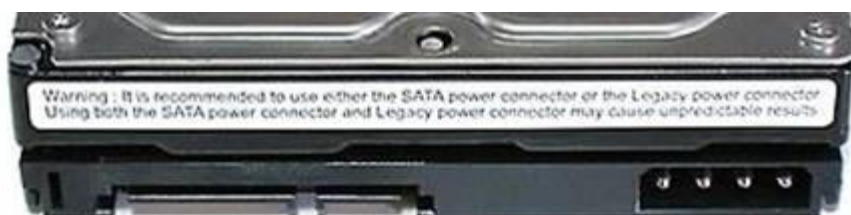
Рисунок – Жесткий диск Serial ATA с возможностью подключения питания Molex и Serial ATA
