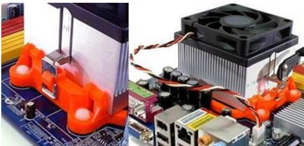
Рисунок – Установка кулера со скобой крепления
