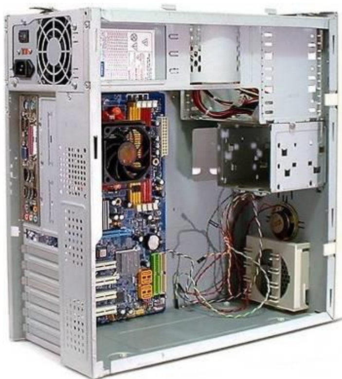
Рисунок – Корпус системного блока с установленным блоком питания и системной платой
