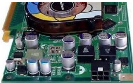
Рисунок – Дополнительный разъем питания видеокарты
