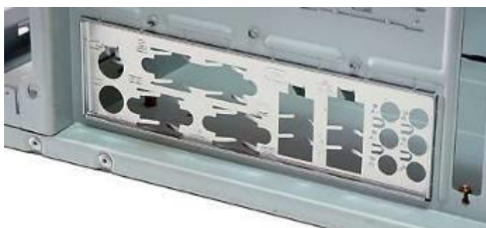
Рисунок – Заглушка, установленная в корпус системного блока
