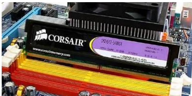
Рисунок – Попытка неправильной установки модуля памяти
