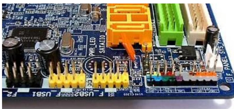
Рисунок – Контакты подключения кнопок и индикаторов
