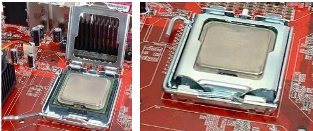
а) б) Рисунок – Этапы установки процессора для сокета LGA-775
