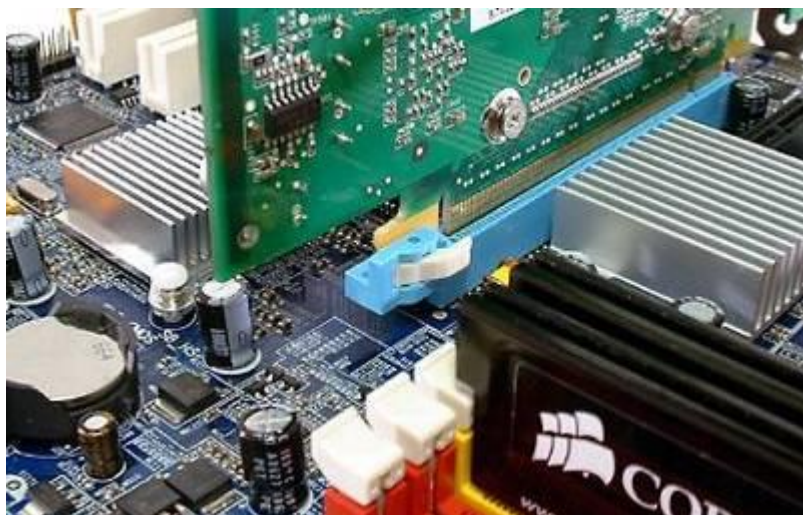
Рисунок – Лапка блокировки видеокарты на системной плате
