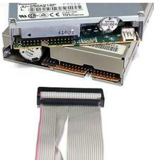
Рисунок – Интерфейсный кабель подключения дисковода FDD
