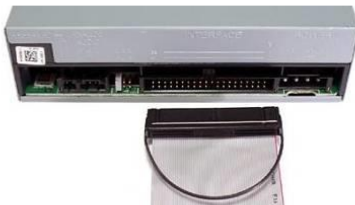
Рисунок – Интерфейсный кабель подключения привода CD/DVD
