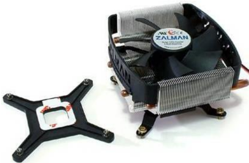
Рисунок – Кулер с винтовым креплением
