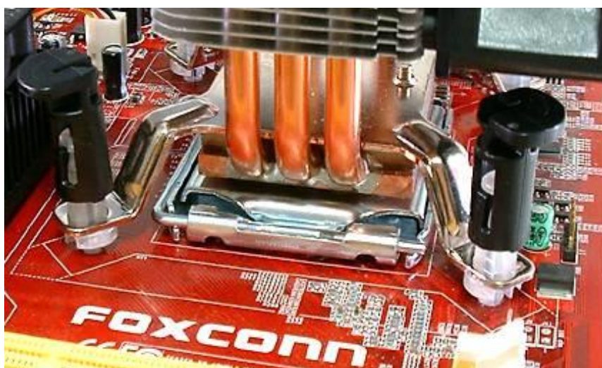
Рисунок – Установка вставляющегося кулера
