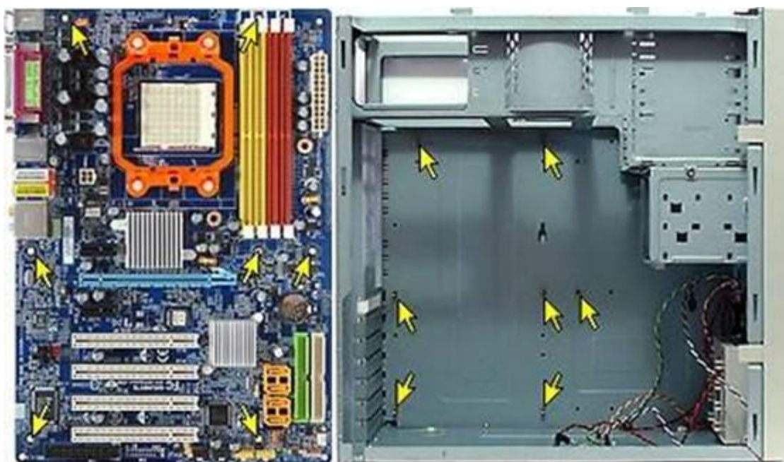
Рисунок – Отверстия крепления системной платы в корпусе
