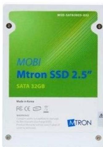
Твердотельный накопитель (англ. SSD, Solid State Drive, Solid State Disk) — энергонезависимое, перезаписываемое компьютерное запоминающее устройство без движущихся механических частей. Следует различать твердотельные накопители основанные на использовании энергонезависимой (RAM SSD) и энергонезависимой (NAND или Flash SSD) памяти.
