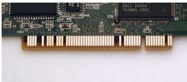
Рисунок – Интерфейс PCI видеокарты
