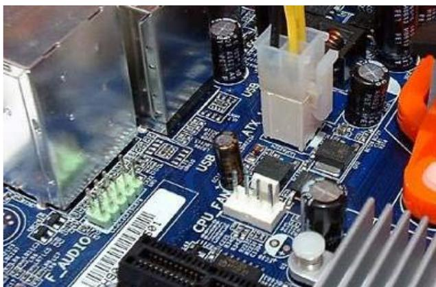
Рисунок – Подключение 4-контактной вилки ATX 12V
