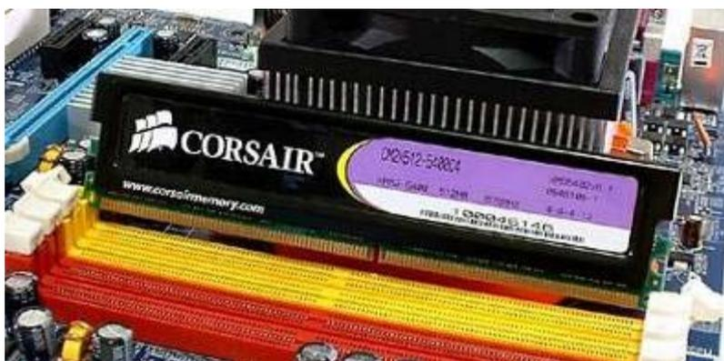
Рисунок – Попытка неправильной установки модуля памяти
