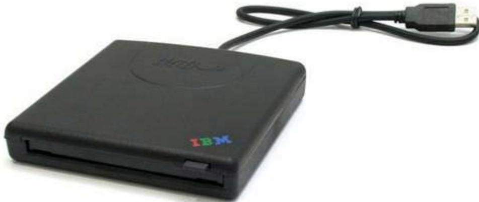
Довольно часто накопители USB или дисководы другого типа включают в себя стандартный накопитель на гибких дисках, выполненный в виде внешнего блока и содержащий интерфейсный преобразователь USB-to-Floppy. В системах типа legacy-free стандартный контроллер накопителя на гибких дисках не применяется, а для подключения накопителя обычно используется шина USB. Иногда накопители подключаются с помощью шины FireWire (IEEE-1394) или параллельных интерфейсов.
