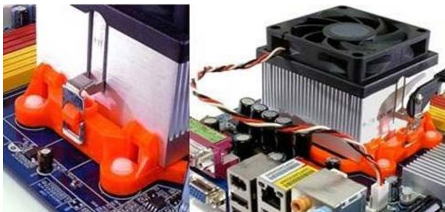
Рисунок – Установка кулера со скобой крепления
