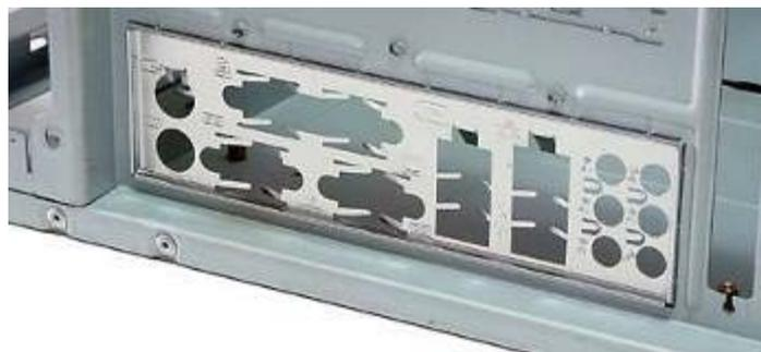
Рисунок – Заглушка, установленная в корпус системного блока
