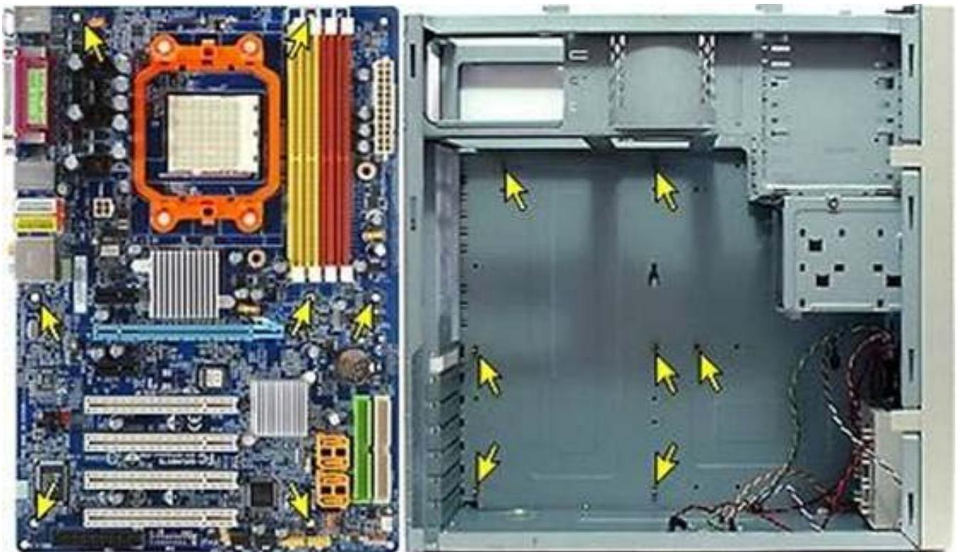
Рисунок – Отверстия крепления системной платы в корпусе
