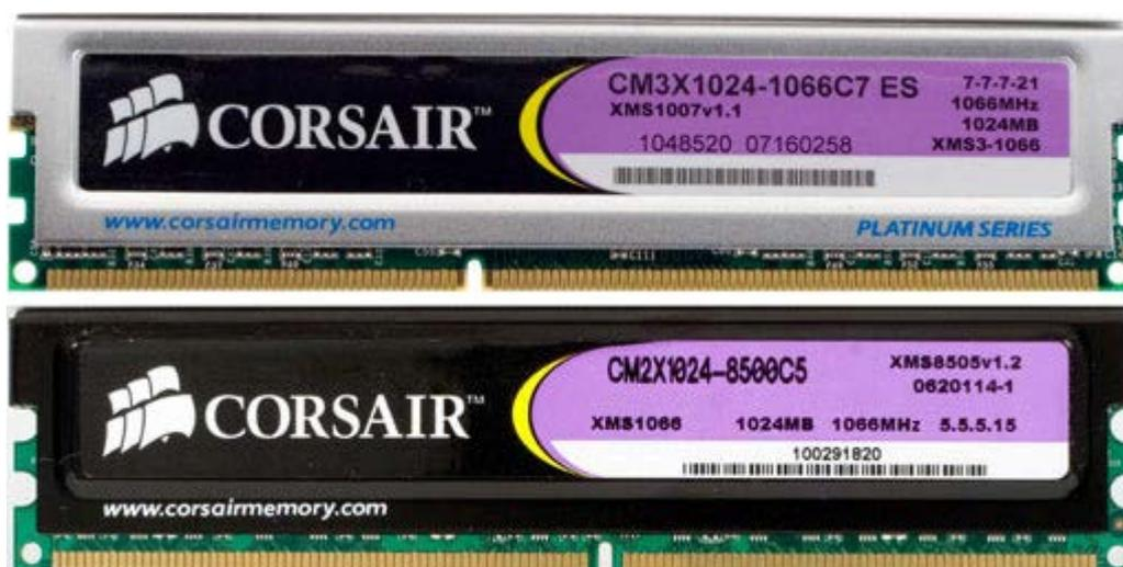
Рисунок – Внешний вид типичных модулей памяти DDR3 (сверху) и DDR2 (снизу)
