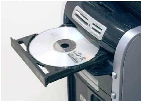
Стандарт компьютерных компакт-дисков CD-ROM (Compact Disk Read-Only Memory) появился в 1985 г. Затем он был дополнен стандартом для записываемых дисков CD-R (CD-Recordable), а в дальнейшем добавился режим CD-RW – Compact Disk Read/Write.
