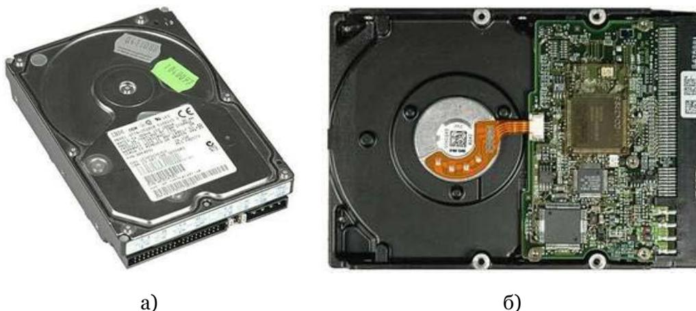
Рисунок – Внешний вид жесткого диска
