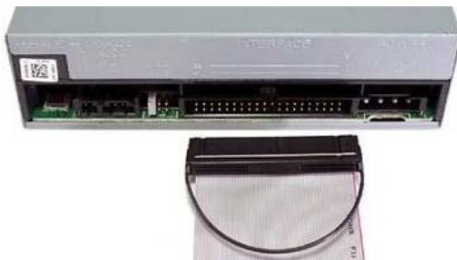
Рисунок – Интерфейсный кабель подключения привода CD/DVD
