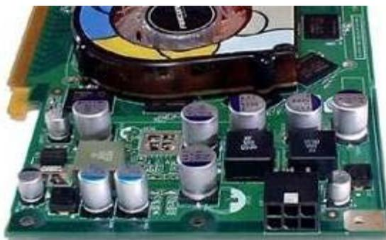
Рисунок – Дополнительный разъём питания видеокарты
