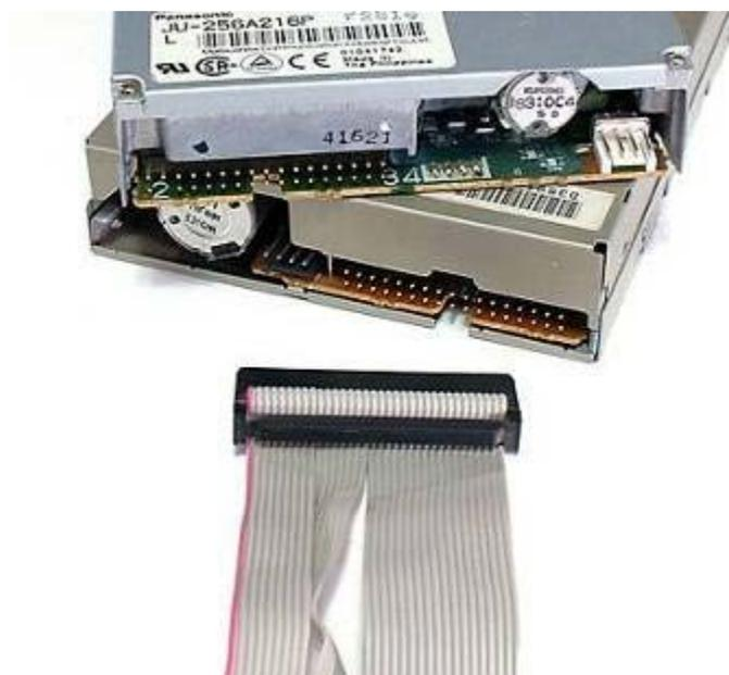
Рисунок – Интерфейсный кабель подключения дисководов FDD
