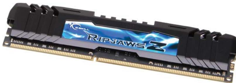
Оперативная память (память с произвольным доступом, Random Access Memory, RAM) в современных настольных системах встречается двух типов – DDR2 и DDR3. Аббревиатура DDR расшифровывается как «удвоенная скорость передачи данных» (Double DataRate) – за один такт по каждой линии передаются два бита данных. Цифра после DDR означает поколение памяти – современная DDR3 быстрее и эффективнее устаревшей DDR2, но платы, предназначенные для DDR2, все еще имеются в продаже.
