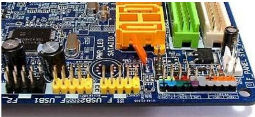
Рисунок – Контакты подключения кнопок и индикаторов
