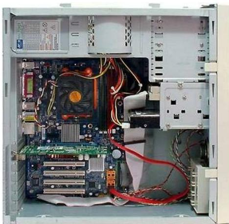
Рисунок – Собранный и укомплектованный персональный компьютер
