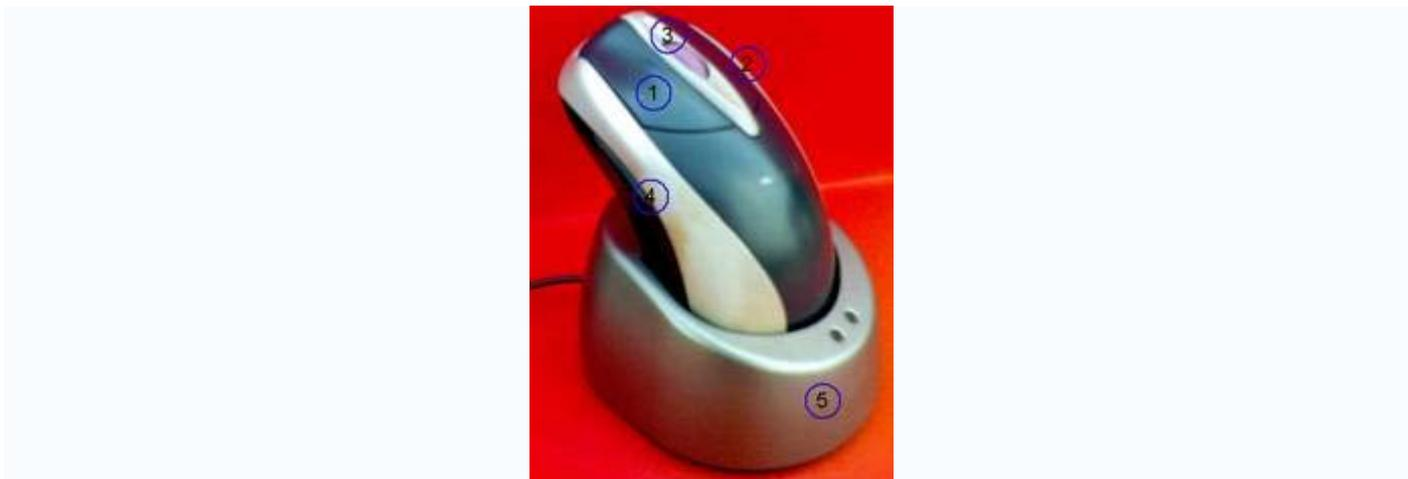
Беспроводная мышь на подзарядке (4 — мышь, 5 — док-станция)
