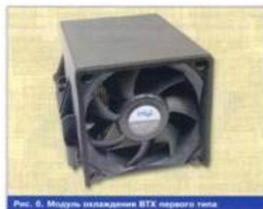
Рис. 6. Модуль охлаждения ВТХ первого типа
