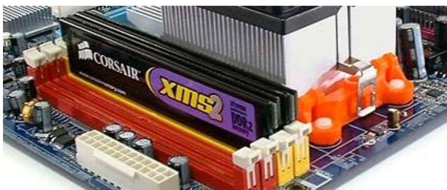
Рисунок – Установленные модули памяти
