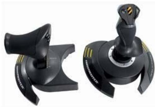
Во многих «авиационных» джойстиках предусмотрена возможность отсоединения блока рукоятки управления двигателем (на фото — TrustMaster Top Gun AfterBurner 2)
