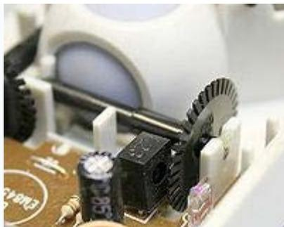
Устройство механической компьютерной мыши
