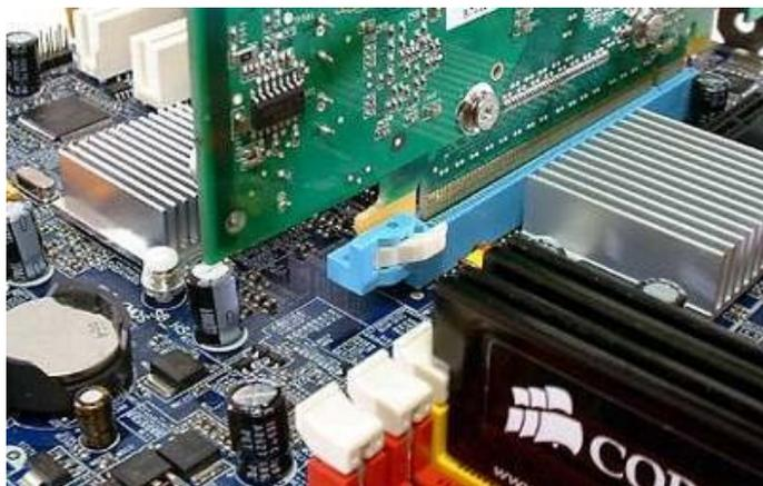
Рисунок – Лопка блокировки видеокарты на системной плате
