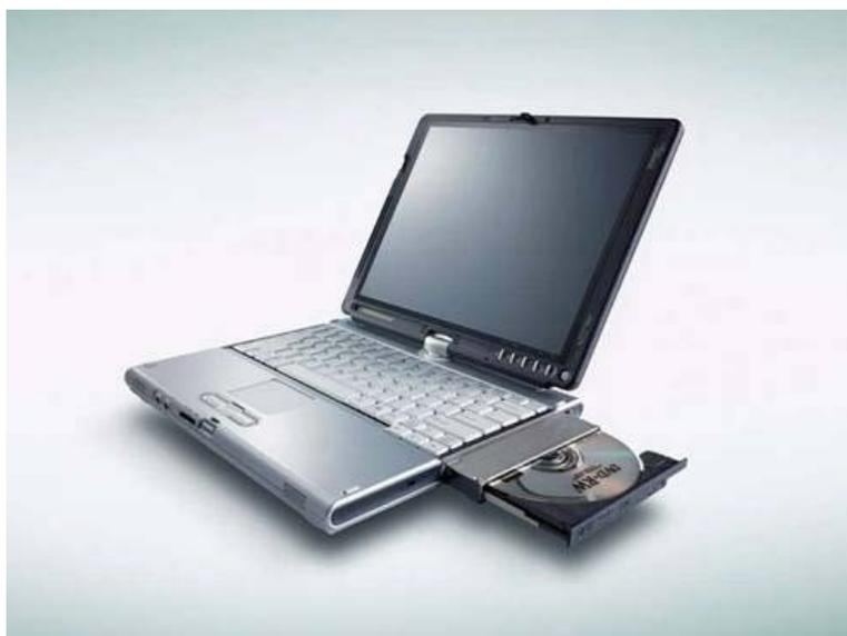
Современный привод компакт-дисков, независимо от стандарта записи, выполняется в виде блока, вставляемого в 5-дюймовый отсек компьютера или встраивается в корпус ноутбука. Для различных применений выпускаются внешние приводы компакт-дисков, смонтированные в отдельном корпусе.
