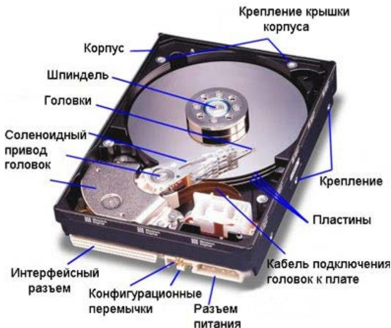
Среди компонентов, из которых состоит жёсткий диск, самые важные - это магнитные пластины, на которые записывается информация, а также головки чтения/записи. Конечно, ничего не будет работать без двигателей, которые заставляют пластины вращаться на высокой скорости и электроники управления, которая играет важную роль в производительности жёсткого диска.
