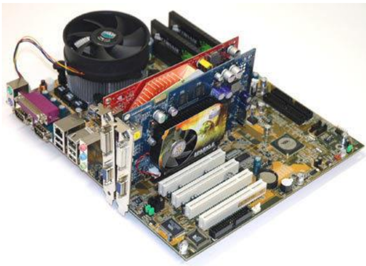
Системная (материнская) плата с установленными комплектующими элементами
