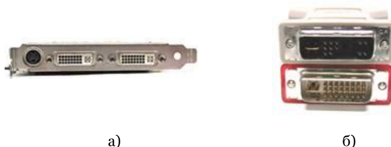
Внешний вид интерфейса DVI: а) задняя панель видеокарты с разъемами DVI, б) интерфейсы DVI на кабеле монитора (сверху DVI-I Single link, снизу DVI-I Dual link)
