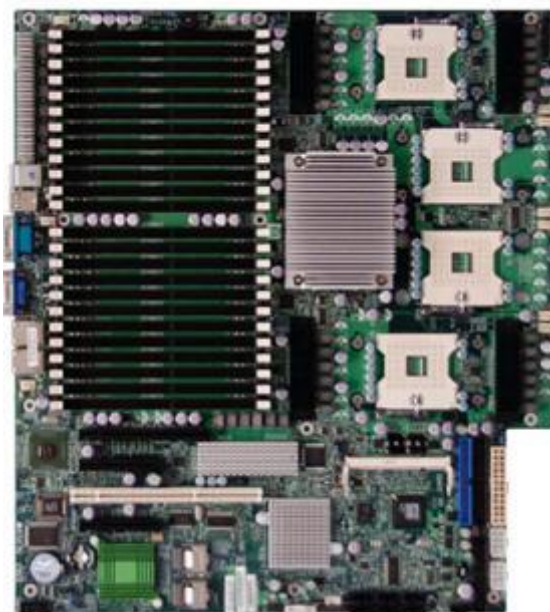
4-процессорная системная плата, в каждый сокет которой можно установить 6-ядерный процессор. В результате мы получим 24-ядерную x86-систему.
