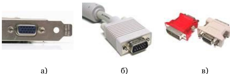
Внешний вид интерфейса VGA: а) задняя панель видеокарты с разъемом мини D-Sub (HD-15) для подключения монитора, б) интерфейс VGA на кабеле монитора, в) переходник DVI -> VGA для видеокарты, оснащенной только разъемами DVI.
