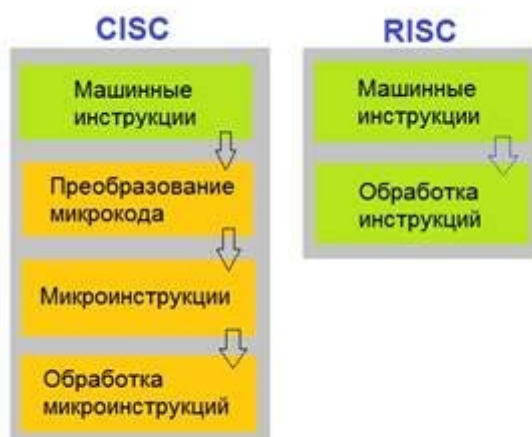
Рисунок 3. Архитектурные отличия процессоров x86 (набор команд CISC) и ARM (набор команд RISC)
